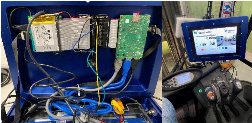
Abbildung 5: Gehäuse mit Raspberry Pi4 und Basissensorik
