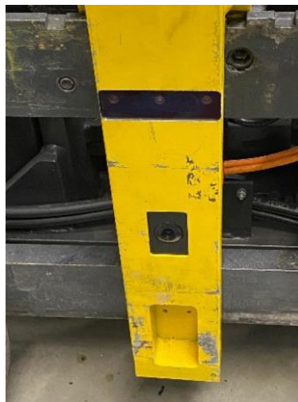
Abbildung 6: "Tote Gabelzinke" mit AI-Kamera und Barcodescanner
